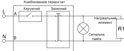
Рисунок 6 – Схема електрична для моделей: N4, N4L, N4s, D400-1-M, PC, D443-1-M
