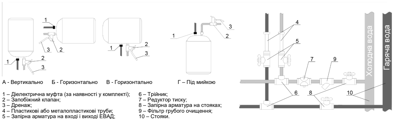
Рисунок 5 – Схеми підключення ЕВАД у вертикальному / горизонтальному положенні та під мийкою
