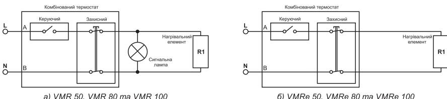
Рис. 6. Схема електрична
